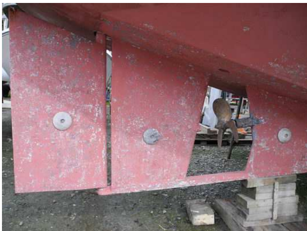
Anodes sacrificielles en zinc sur une coque de bateau
